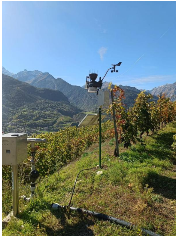
Stazione agrometeorologica Davis Vantage Pro – sito TORRETTE (Saint-Pierre)
