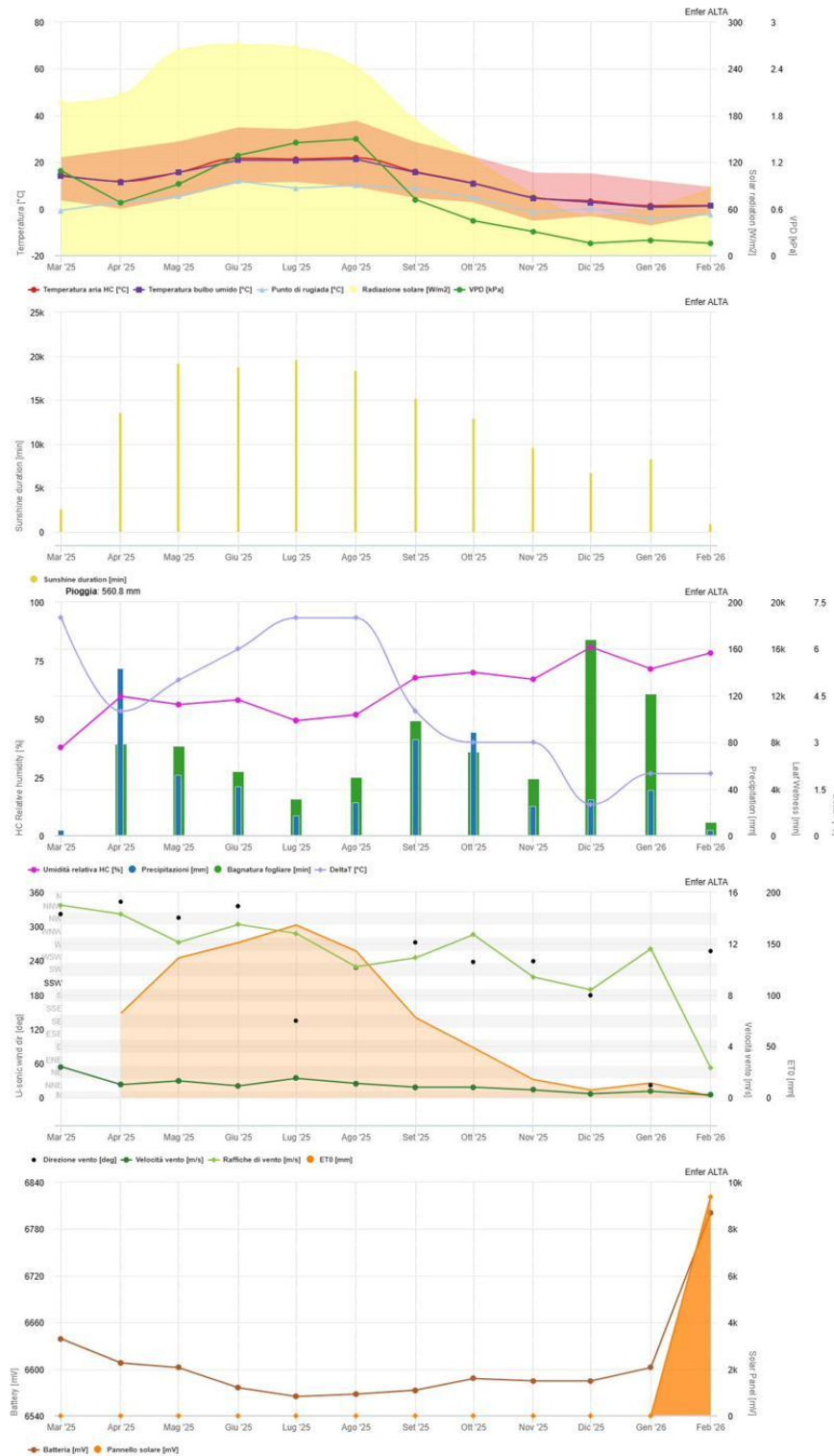
Esempio di elaborazione dei dati agrometeorologici stagionali rilevati dalla stazione (sito Enfer Alta): temperatura, radiazione, precipitazioni, bagnatura fogliare, vento, ETO e stato di carica dell'alimentazione.
